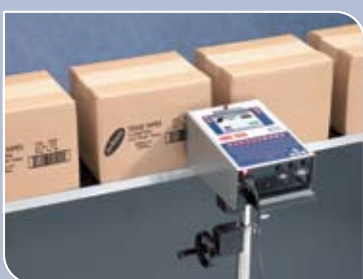
Принтер 7000 QUATTRO, установленный на конвейере
